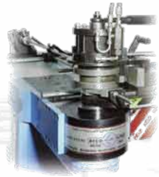
Above and under head actuated split dies Apertura matriz por arriba o abajo del cabezal
