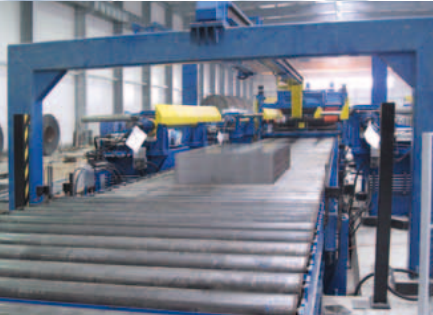
Zona di spazzolatura con aspiratore per acciaio laminato a caldo Brushing zone with aspirator for hot rolled steel Strefa szczotkowania z pochłaniaczem do blach gorącowałcowanych Зона чистки щетками с вытяжным устройством для горячекатаного металла
