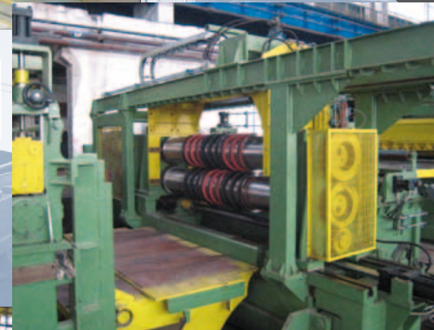
Linea di taglio longitudinale 2000x8mm
