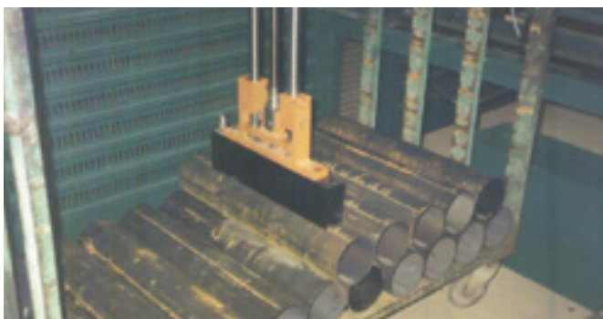
Pallettizzatore magnetico. Magnetic palletizer.
